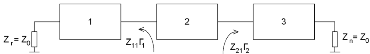
Рис. 1.4. Согласование транзистора с генератором и нагрузкой: 1 – согласующая цепь СЦ1; 2 – транзистор; 3 – согласующая цепь СЦ2
